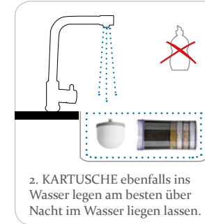
1. KERAMIKFILTER: mit dem Boden nach oben vollst. bedeckt in Leitungswasser legen
